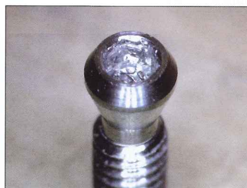
Foto 26. Coronamiento tornillo a 16,30 N.cm
