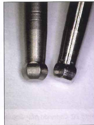
Foto 15: Comparativa destornillador Talladium-IClönne
