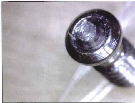
foto 50 . detalle rotura llave
