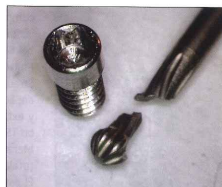
foto 69. Tornillo activo después de rotura de la llave
