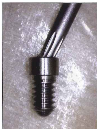
foto 64. Conexión tornillo-llave máx. angulación 32°
