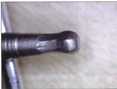
foto 49: bola deformada después.
