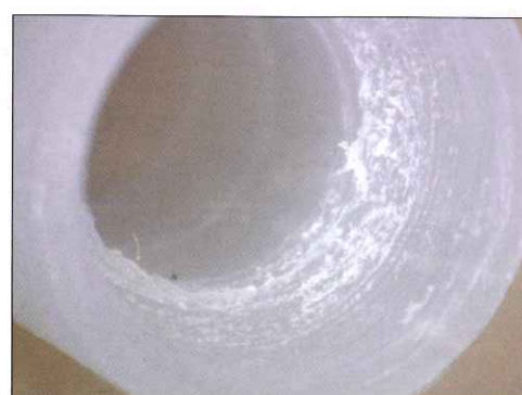
foto 42. Detalle rebabas mecanizado.
