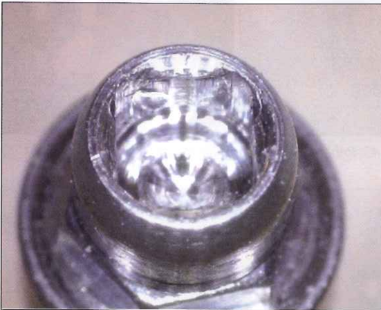
foto 58. Después de la rotura de la llave el tornillo permanece activo
