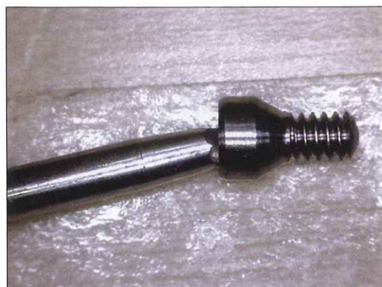
Foto 31. Montaje tornillo-destornillador, angulación max. 14°
