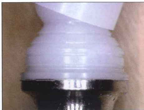
Foto 29. conexión pilar-implante, Detalle rebabas.
