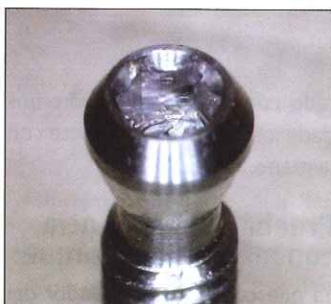
Foto 25a. Coronamiento tornillo a 15,5 N.cm
