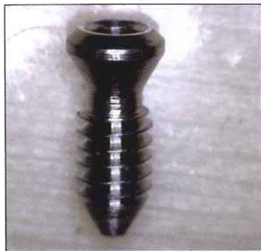
foto 46. Rebabas cabeza tornillo M2
