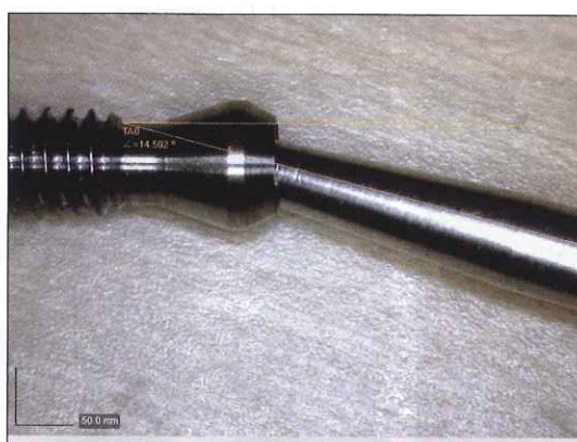
Foto 23. Montaje tornillo-destornillador máx. angulación, 14,50°
