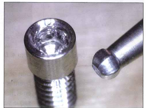
Foto 9. Tornillo coronado con 30 ciclos.
