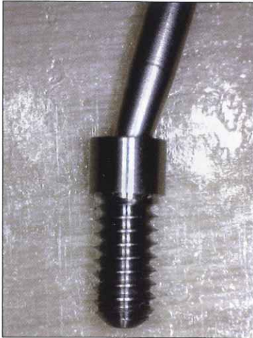
Foto 5. Posición max. Angulación tornillo/destornillador
