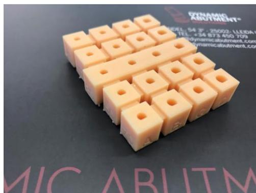
3. a. **Posicionamiento anti-rotativo X,Y:** Coger la réplica digital correspondiente e ir posicionándola en los diferentes orificios –según la compatibilidad de la tabla– y comprobar cuál es el mejor ajuste para su impresora.
