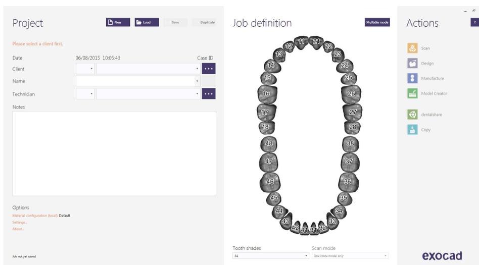
En ésta pantalla se define cliente, paciente, técnico, tipo de trabajo, materiales, etc. Se define completamente el trabajo sin especificar marca y modelo de implante. Definir que se trabajará con implante, ya que la reconstrucción estará basada en uno o varios implantes dependiendo si el trabajo es unitario o múltiple.
