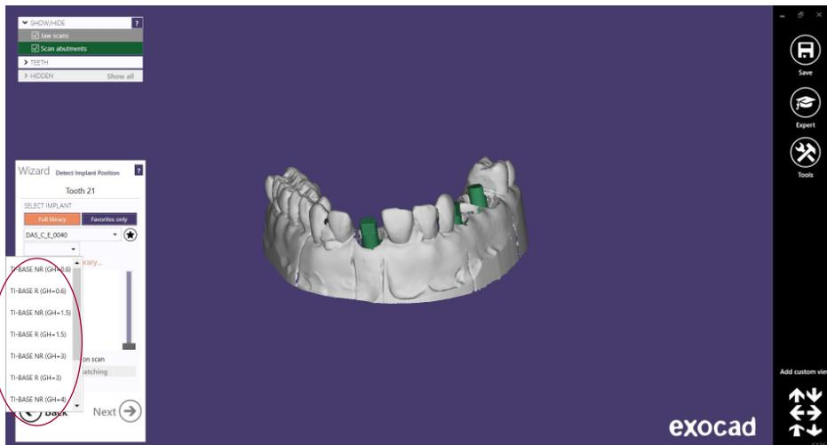
Una vez seleccionado el tipo de trabajo a realizar, se procede a seleccionar si se desea trabajar con canal angulado recto (0°) o canal angulado de hasta 25° o 45°.
