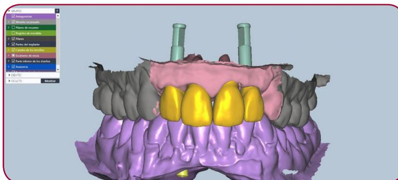
Diseño en Exocad, coronas para estratificar en disilicato de litio. Vemos el diseño a volumen total para después reducir.
