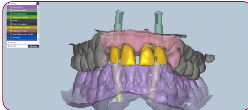
Diseñamos en Exocad centrales sobre muñón natural y laterales cemento-atornillado sobre interfases Talladium. Para estratificar.
