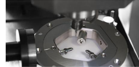
Soporte tipo disco estándar de diámetro de 98mm para posicionar de manera rápida y precisa 3 cilindros con sujeción posterior a la conexión del implante.
