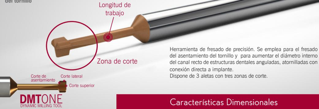
Herramienta de fresado de precisión. Se emplea para el fresado del asentamiento del tornillo y para aumentar el diámetro interno del canal recto de estructuras dentales anguladas, atornilladas con conexión directa a implante. Dispone de 3 aletas con tres zonas de corte.
