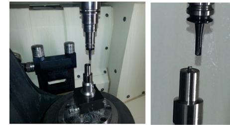
Soporte para máquinas CNC con cabezal rotatorio compatible con el sistema EROWA 10x10.
