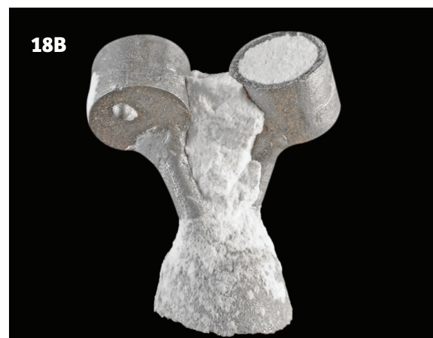
FIGURA 18: Observe en la imagen arriba la ausencia de revestimiento adherido a las superficies de la aleación fundida. En estas se hicieron las eliminaciones de revestimiento solamente con martillo neumático, sin el uso de arenado. En la imagen 18A, observe que el revestimiento no tiene el color oscuro típico de la reacción. En la imagen 18B, observe cómo se han copiado con exactitud los bordes finos y afilados. Hay una protuberancia de metal sobre la superficie de una de las cofias que se colocó sólo para diferenciar dos patrones de cera.
