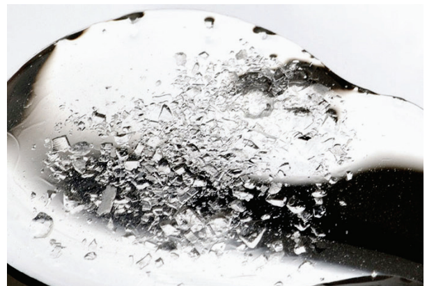
FIGURA 7: La imagen muestra el líquido de revestimiento con cristales de sílice, debido al almacenaje inadecuado. Compruebe si la botella que estas comprando presenta tales cristales en el fondo. En el caso de que si, evite la adquisición de esta botella.
