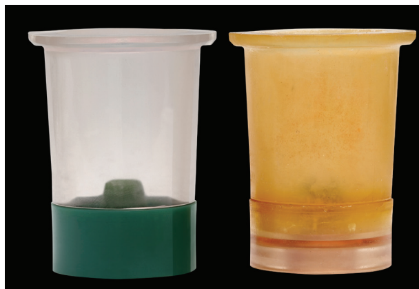
FIGURA 8: La imagen de la izquierda muestra un cilindro de silicona adecuado y flexible. En la imagen de la derecha puedes ver un cilindro de silicona ya envejecido por el tiempo y/o mal uso. Debido a su rigidez la expansión correcta del revestimiento es impedida, por lo tanto debe ser sustituido.
