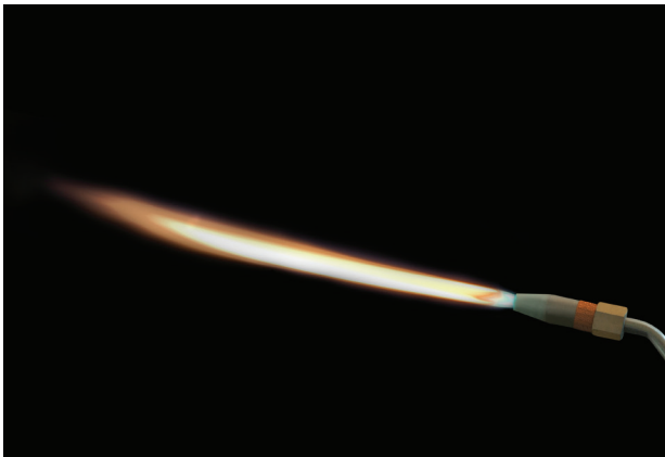
FIGURA 13: Llama inadecuada con exceso de gas de cocina en la mezcla.
