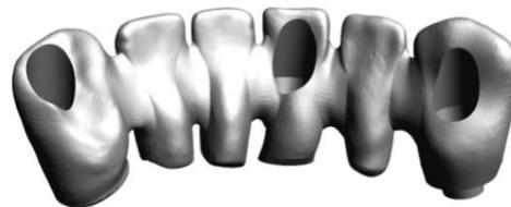
Para hacer posible una angulación-corrección de 30° y permitir el paso de cualquier tornillo, el diseño y fresado de las chimeneas de entrada del tornillo debe realizarse en dos fases.
