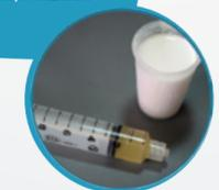
**2** En seguida ponga en el vaso milimetrado la cantidad de NOVOX Base que será utilizada en el modelo, y adicione la cantidad de NOVOX Colorante necesaria mezclando hasta conseguir el color deseado
