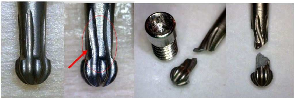
Imágenes de Estado Inicial, inicio de deformación y rotura de destornillador.
