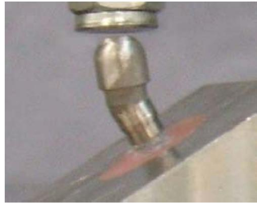
Figura 2b. Configuración del ensayo: pilares angulados.
