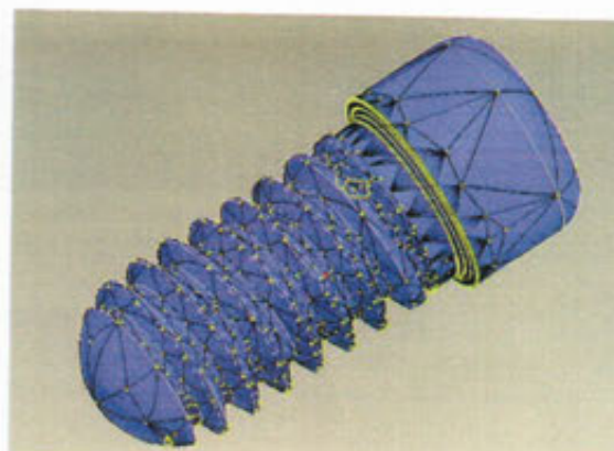
Figura 15. Malla de elementos finitos adaptados a la geometría de la pieza
