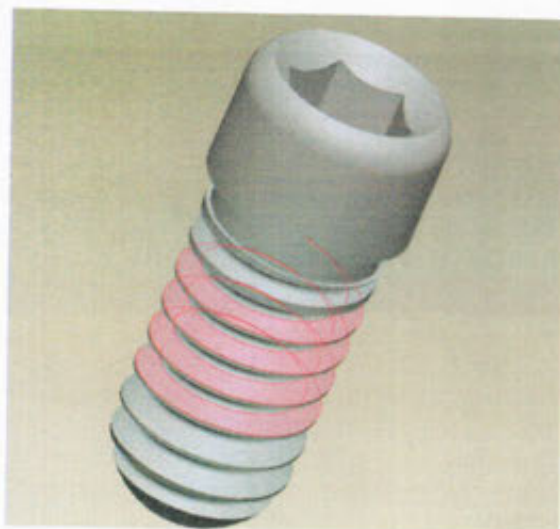
Figura 13. Superficie de la rosca sobre las que se aplican las restricciones de movimiento que simulan el contacto
